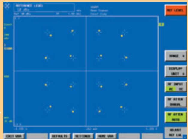
◀ BILD 13 Nichtlineare Verzerrungen, 16QAM-Konstellati- onsdiagramm.
